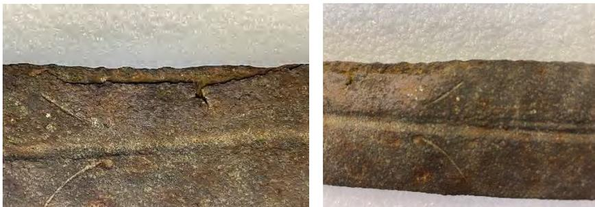
**Fig. 19 y 20. Pérdidas de material que generan debilidad estructural del metal en esta zona**
