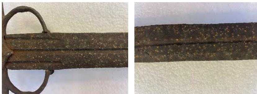
**Fig. 22 y 23. Corrosiones por picadura generalizadas en el reverso**
