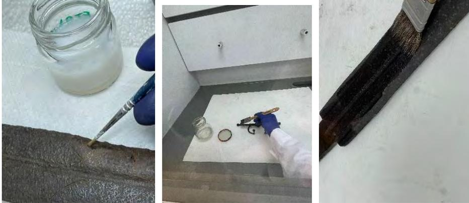
**Fig. 37, 38 y 39. Aplicación de ácido tánico de forma puntual y benzotriazol en toda la superficie**
