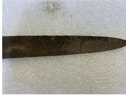
**Fig. 21. Detalle de zona descarnada por impacto de un rayo**
