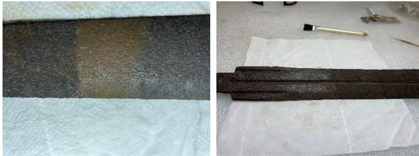
**Fig 35 y 36. Catas de nivel de limpieza y proceso de media limpieza del anverso de la hoja**
