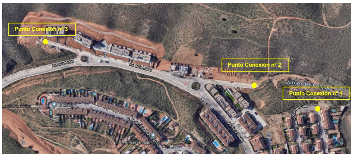
Puntos de conexión para el abastecimiento de la Urbanización del PAU Montecigarrales
